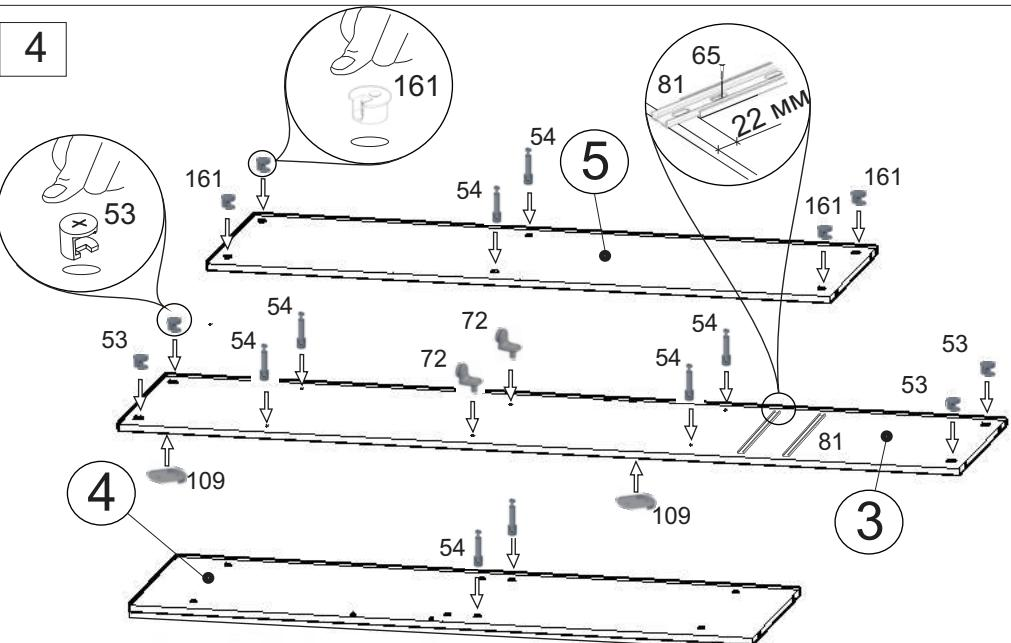
Допускается небольшое несоответствие кернения в связи с разными производителями направляющих.
