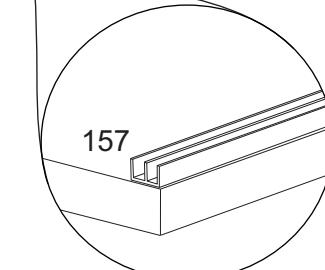
Во избежание потертостей деталей монтаж фурнитуры производить на любом предохранительном материале
