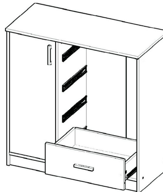
**13** После окончательной сборки установить ящики на направляющие 83. Во всех видимых местах в головку конфирмата 51 установить заглушку конфирмата 52, в эксцентрик 53 установить заглушку эксцентрика 55.
