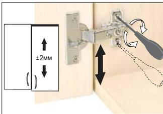
Слегка ослабить крепежные винты ответной планки. Выровнять по высоте позицию двери. Затем крепежные винты снова затянуть.
