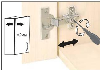
Ослабить крепежный винт и отрегулировать расстояние между дверью и боковиной шкафа. Затем снова затянуть крепежный винт.
