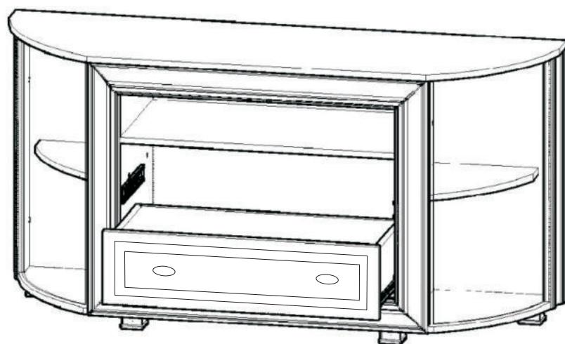
После окончательной сборки установить ящики на направляющие 83, полки на полкодержатели 72.
