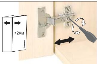
Ослабить крепежный винт и отрегулировать расстояние между дверью и боковой панелью шкафа. Затем снова затянуть крепежный винт.
