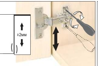
Слегка ослабить крепежные винты ответной планки. Выровнять по высоте позицию двери. Затем крепежные винты снова затянуть.
