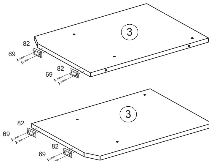
Во избежание потертостей деталей монтаж фурнитуры производить на любом предохранительном материале
