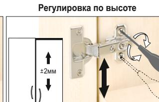
Слегка ослабить крепежные винты ответной планки. Выровнять по высоте позицию двери. Затем крепежные винты снова затянуть.
