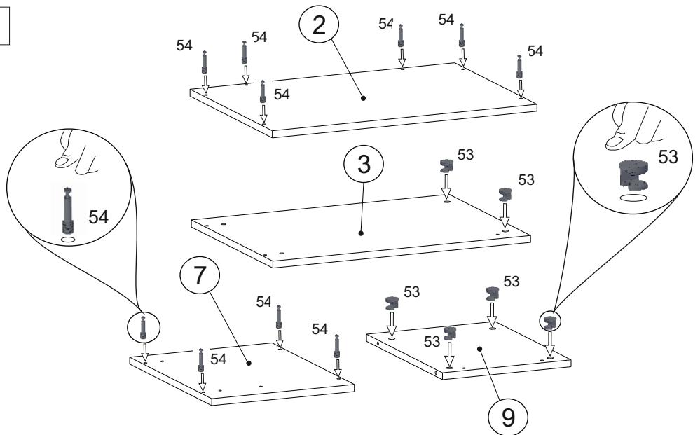
Во избежание потертостей деталей монтаж фурнитуры производить на любом предохранительном материале
