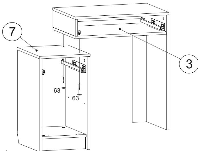
\* Для сборки изделия длиной 800мм необходимо досверлить отверстия в детали 7 и закрепить к детали 3 винтами 63.
